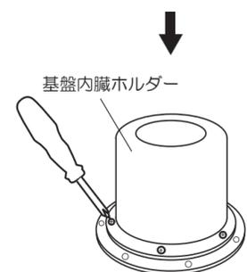
2. 基盤内臓ホルダーを本体から取り出し6箇所のビスをプラスドライバーを使い外してください。
