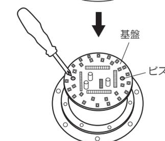
3. 基盤の2箇所のビスをプラスドライバーを使い外してください。
