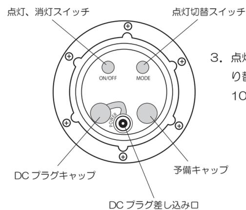
3. 点灯切替スイッチを押すと明るさが3段階で切り替わります。
