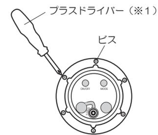
1. 本体底面の6か所のビスをプラスドライバーを使い外してください。
