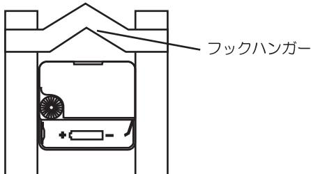
1. 電池ホルダーの+と-を確かめ、単三乾電池を確実に電池ホルダーに入れてください。
