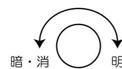
下部ソケットの電球は、スイッチBを時計回りに回すと点灯、消灯の繰り返しです。
