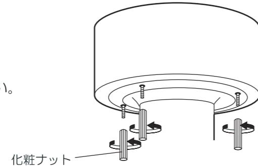
3. 器具本体をしっかりと手で持ちながら引掛プラグを天井接続器に「カチッ」と音がするまで確実に回して取り付けて下さい。
